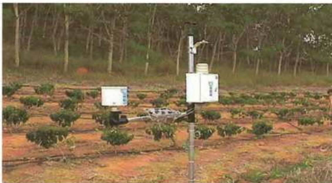
Figura 3 – Estação meteorológica automática instalada na área experimental.
