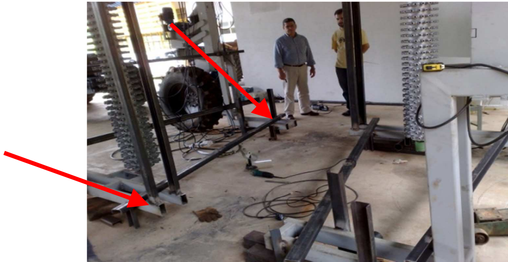
FIGURA 1.31 Detalhe do corte para o alongamento do chassi realizado no LMA.
