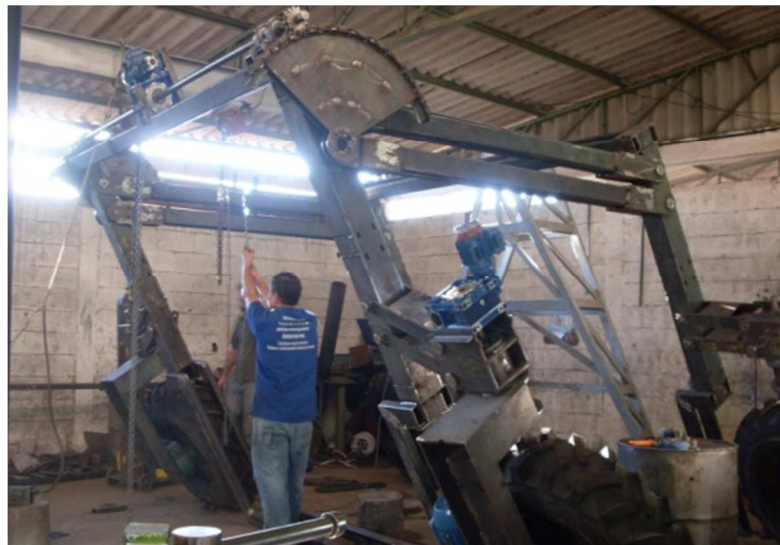
FIGURA 1.27 Levantamento da estrutura definitiva do chassi.
