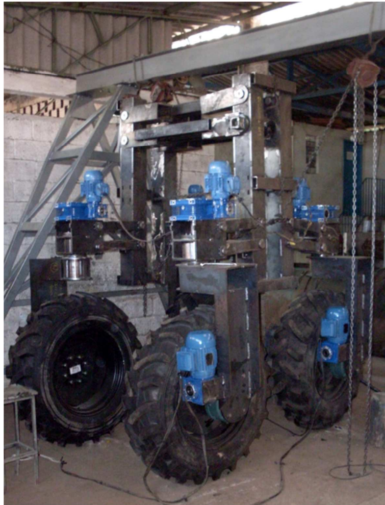
FIGURA 1.22 Alinhamento provisório das colunas e ligação provisória dos motorreductores da direção
