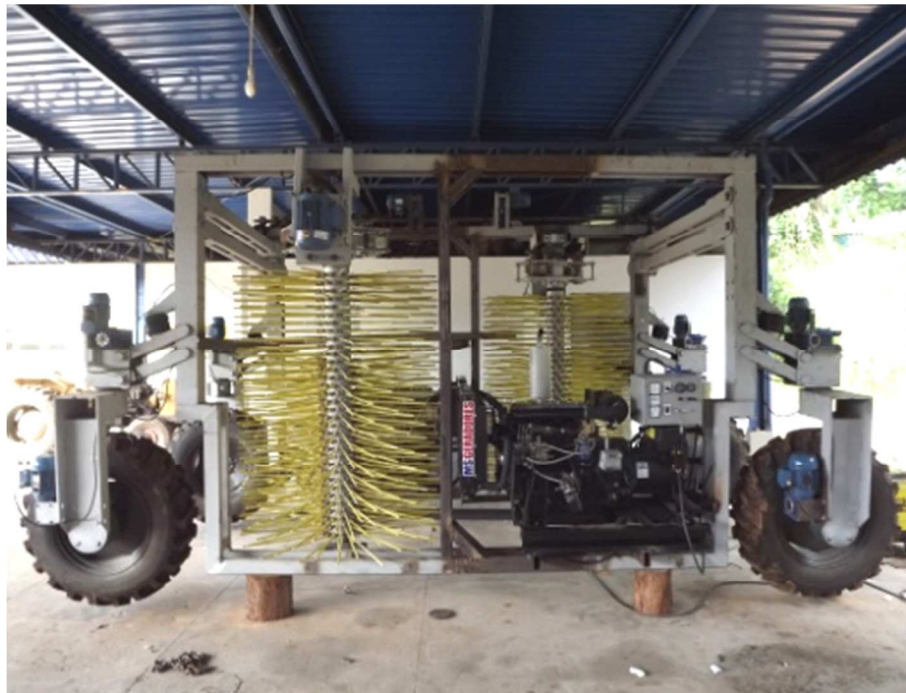
FIGURA 1.32 Colhedora com os motogeradores instalados.
