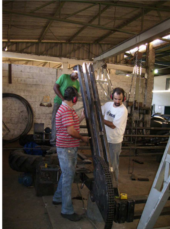
FIGURA 1.26 Detalhe da montagem das barras pantográficas no mecanismos de articulação do chassi.
