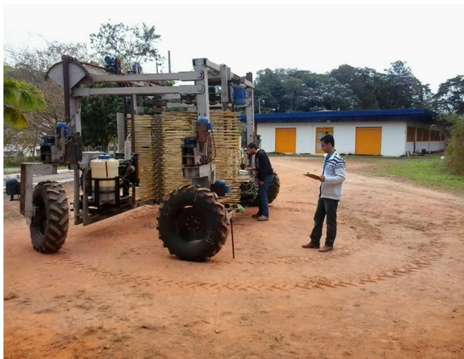
FIGURA 3.06 Ensaio do raio de giro da colhedora de café.
