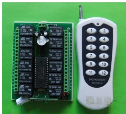
FIGURA 2.04 Imagem do controle remoto mais receptor 12 canais.
