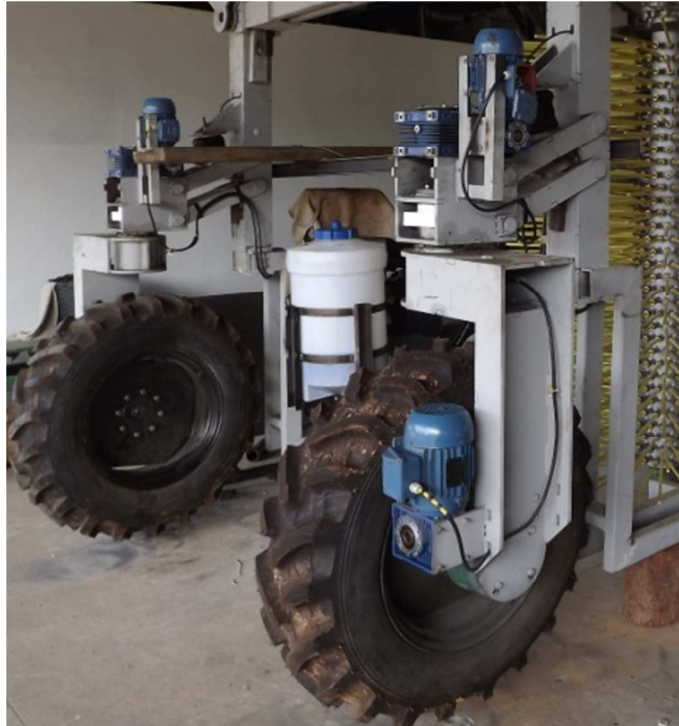
FIGURA 2.02 Mecanismo de direção da colhedora de café.
