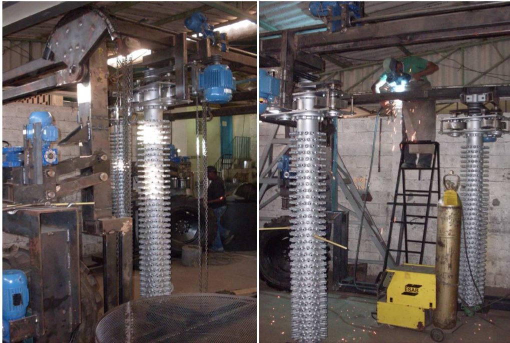
FIGURA 1.28 Montagem dos cilindros agitadores.
