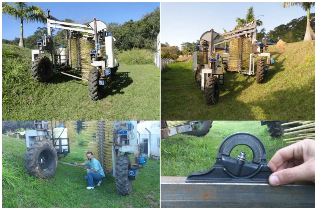
FIGURA 3.12 Colhedora deslocando em talude com 50% inclinação.
