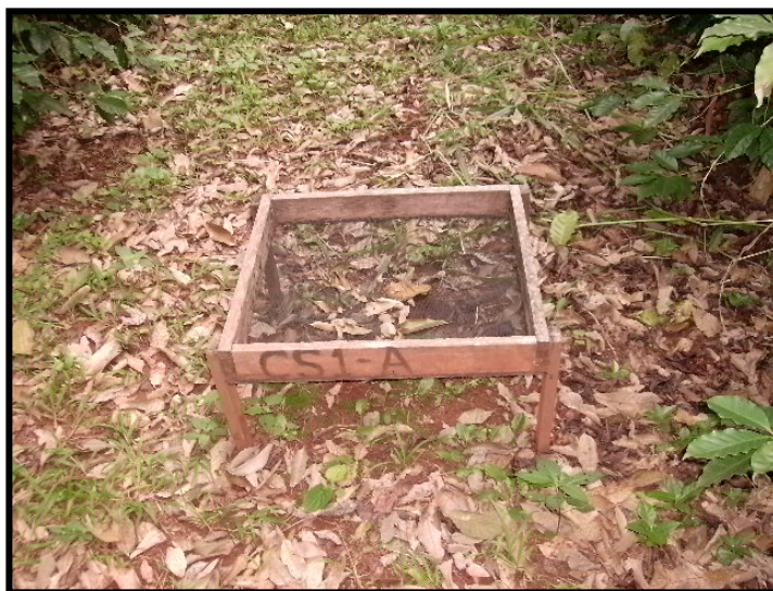
Figura 3 - Bandeja coletora de serapilheira instalada no centro da entre fileiras de cafeeiros
