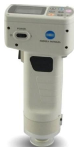
Figura 22 Colorímetro utilizado para as medições de L^*a^*b^* das cartelas de cores Fonte: Minolta (2015)
