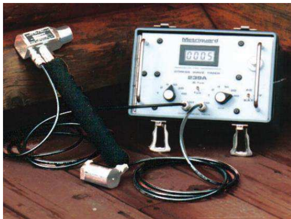
Figura 3. Stress Wave Timer. Modelo 239A. Fonte: Metriguard (2014), utilizado para o teste de pulso ultrassônico
