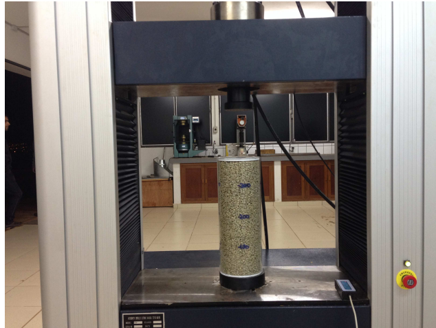
Figura 2. Configuração experimental com a Máquina de Ensaio Universal e com o silo modelo preparado para o teste. UFLA, Lavras, MG, Brasil, 2014.
