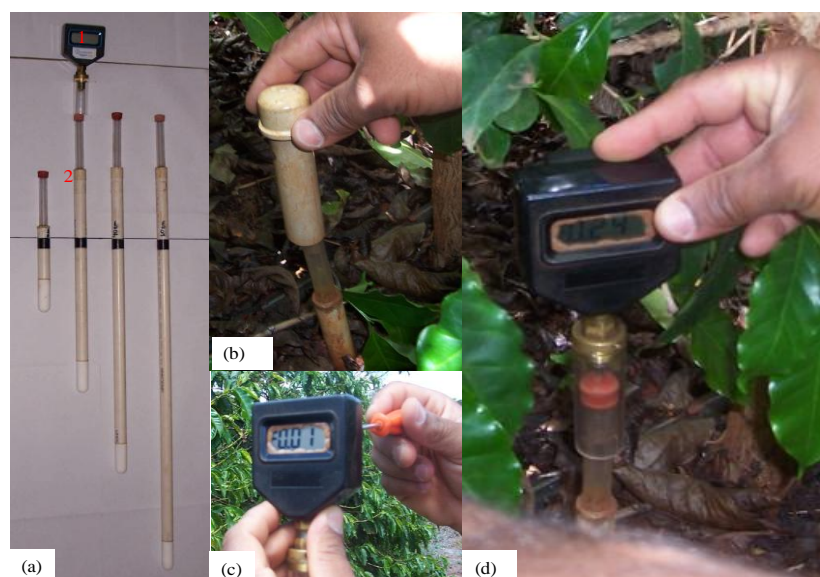
Figura 2 Sequência de ilustrações apresentando detalhes dos tensiômetro (a 1 ) com vacuômetro digital ou tensímetro de punção digital (a 2 ) utilizado no experimento; (b) verificação do nível da coluna de água dentro dos tensiômetros; (c) ajuste na leitura do tensímetro para obtenção do valor zero quanto o aparelho não estiver sob tensão de água no solo e (d) leitura da tensão de água no solo (bar), Lavras-MG. UFLA, 2015
