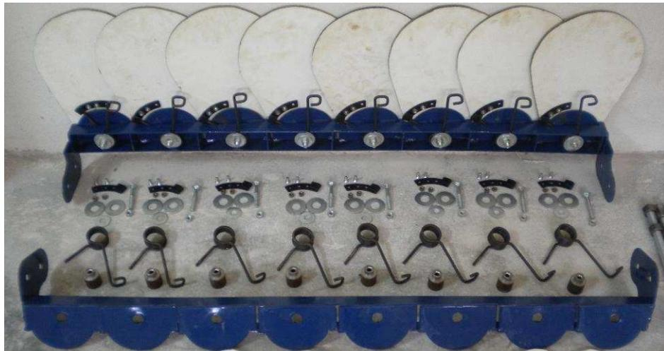
Figura 43 – Mecanismo de lâminas retráteis utilizado no sistema de recolhimento
