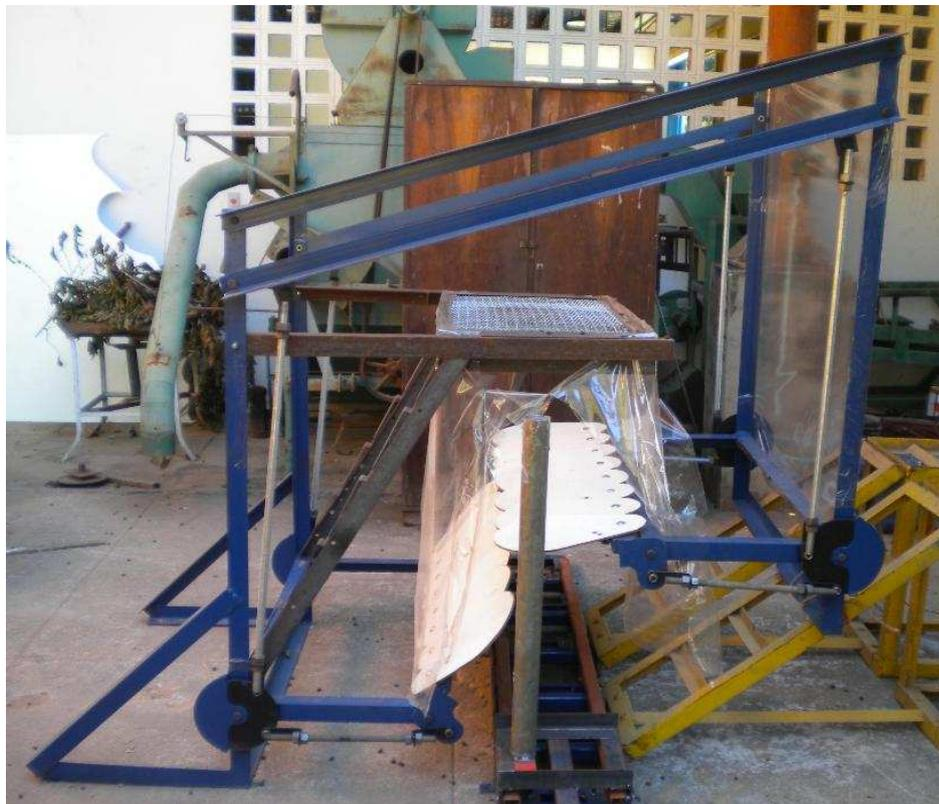
Figura 45 – Estrutura do mecanismo recolhedor simulando um ambiente de alta declividade.
