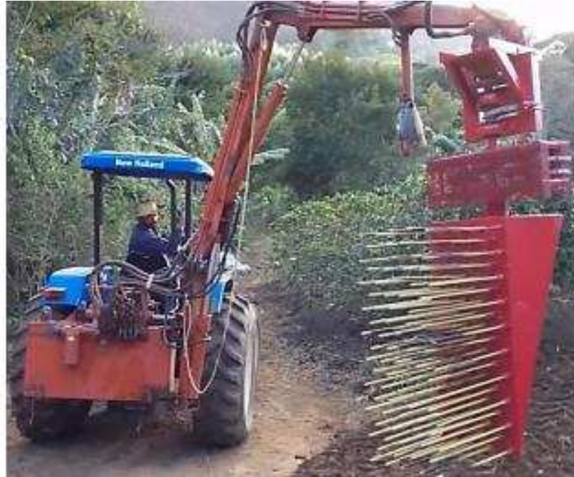
Figura 2 - Protótipo da derriçadora de café desenvolvida por MOREIRA (2015).
