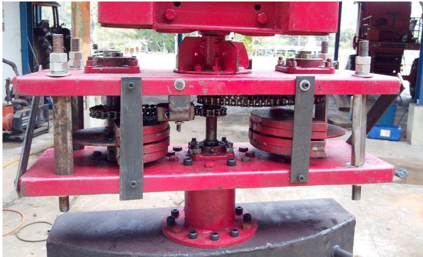
Figura 17 - Mecanismo da massa excêntrica refeito e com novos reforços.
