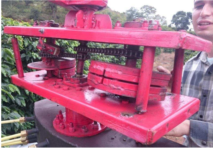
Figura 16 - Suportes do mecanismo da massa excêntrica quebrados.
