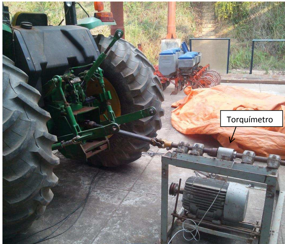
Figura 11 - Ligação da TDP a bancada com o torquímetro.
