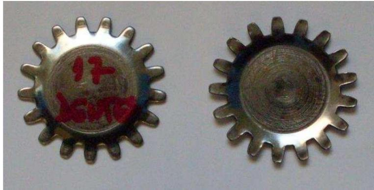
FIGURA 15 – Engrenagem em chapa estampada de aço inox utilizadas na confecção dos roletes.
