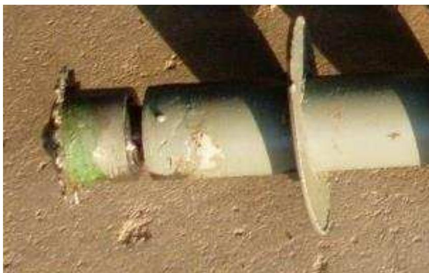
FIGURA 14 – Acabamento final da extremidade de uma das unidades dos roletes com engrenagens.
