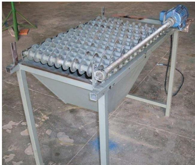
FIGURA 28 – Quadro estrutural com moega de despejo, quadro de roletes e mecanismo de acionamento.
