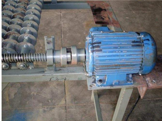
FIGURA 19 – Disposição do eixo de rosca sem fim, dos roletes e do motor elétrico.
