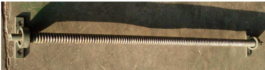
FIGURA 21 – Eixo de rosca sem fim com os flanges de fixação.
