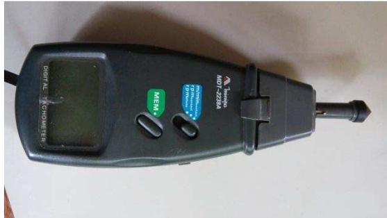
FIGURA 24 – Tacômetro de contato MINIPA modelo 2238A.
