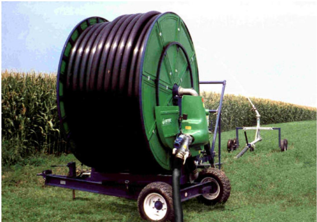
Figura 6 – Autopropelido com tracionamento pela mangueira.
