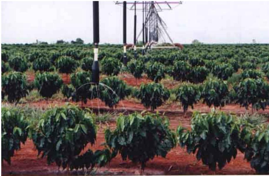
Figura 9 – “Spray” Lepa de irrigação localizada em pivô central.
