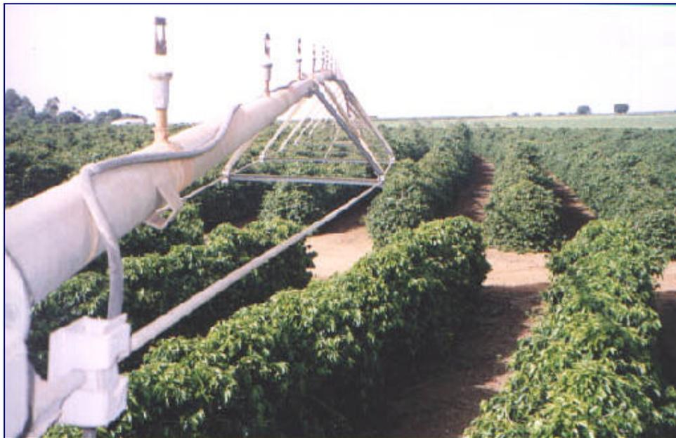
Figura 7 – Pivô central equipado com “sprays” sobre plantio convencional de café.
