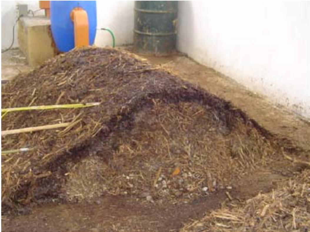
Figura 4.10: Detalhe do perfil de distribuição de água no material constituinte da Leira Estática Aerada 01.
