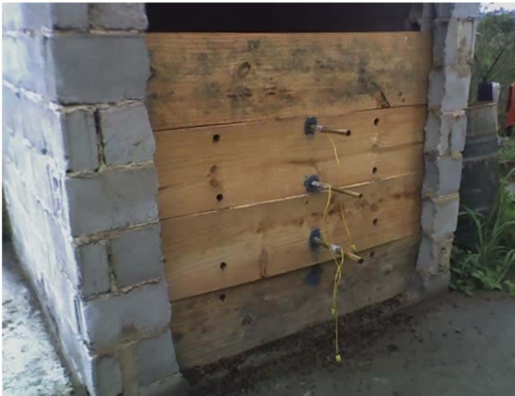
Figura 3.14. Pontos de amostragem e de determinação de temperatura na composteira.
