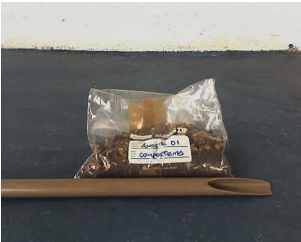
Figura 3.15. Detalhe do amostrador, em tubo de PVC de  $\frac{3}{4}$ ", utilizado para a coletar amostras na composteira, juntamente com uma amostra já coletada e acondicionada para análise.
