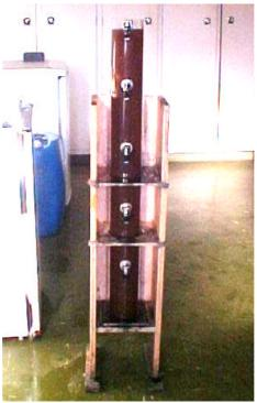
Figura 2- coluna de sedimentação em acrílico utilizada para determinação dos sólidos em suspensão em função do tempo.
