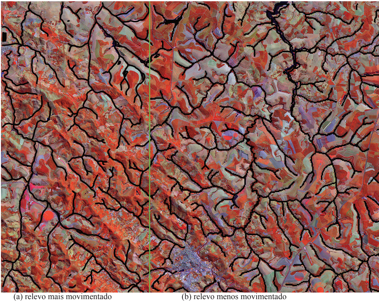
FIGURA 4 – Imagem composição RGB com máscara de drenagem: (a) relevo mais movimentado (b) relevo menos movimentado.
