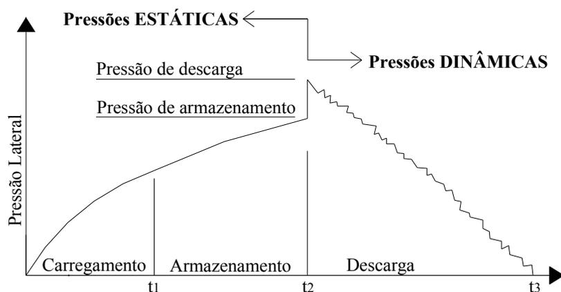
FIGURA 18 Pressões nas paredes do silo para um ciclo de operação de carga, armazenamento e descarga.
