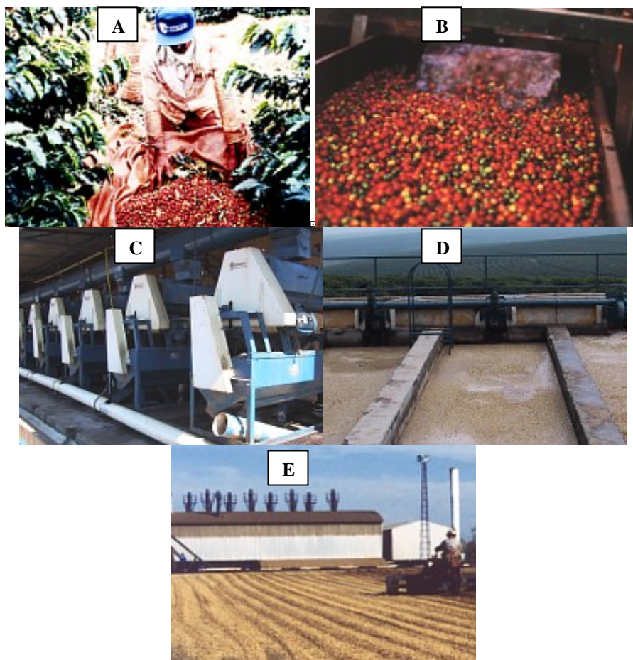
FIGURA 2 Etapas do processamento do café via úmida A- Colheita de frutos cerejas; B- Lavagem e seleção dos frutos para processamento; C- Despulpamento dos grãos; D- Tanque de fermentação para remoção da mucilagem; E- Terreiro para secagem dos grãos após a remoção da mucilagem.
