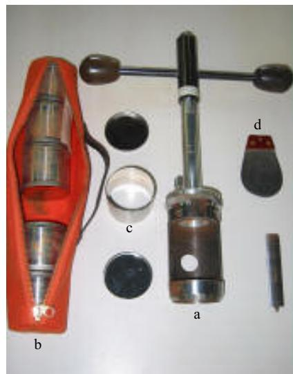
FIGURA 3.9 Trado (a) utilizado na coleta de amostras indeformadas e acessórios como (b) sacola com cilindros de aço de 100cm<sup>3</sup>, (c) cilindro com as tampas e (d) espátula para retirada do cilindro de dentro do trado.
