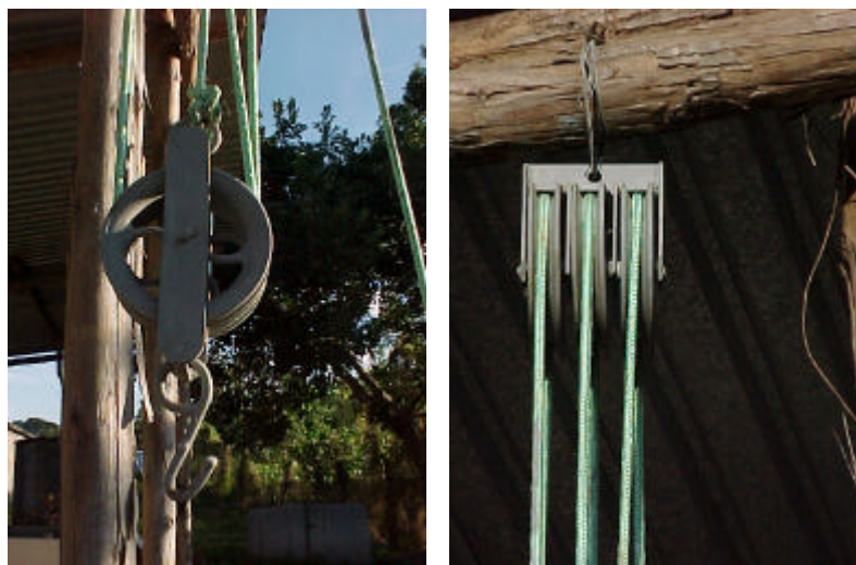
Figura 2: Sistema de roldanas para o revolvimento das câmaras de secagem
