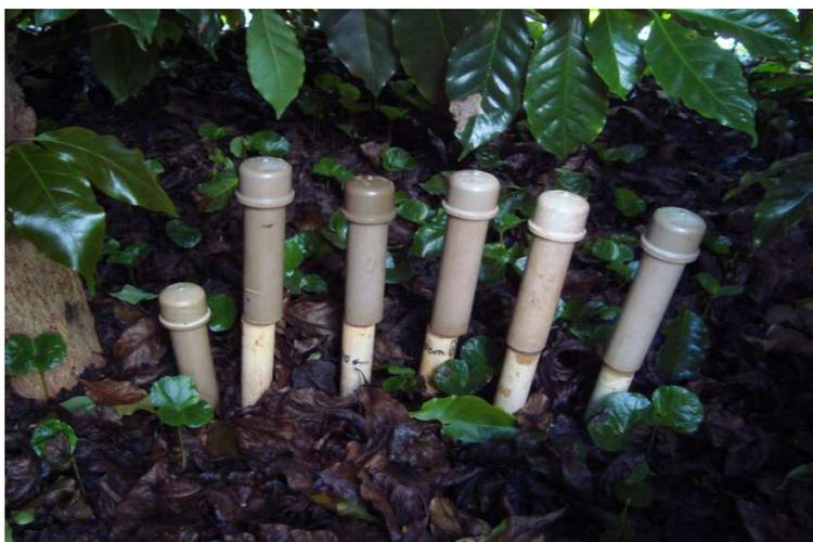
Figura 1 Tensiômetros instalados na área experimental
