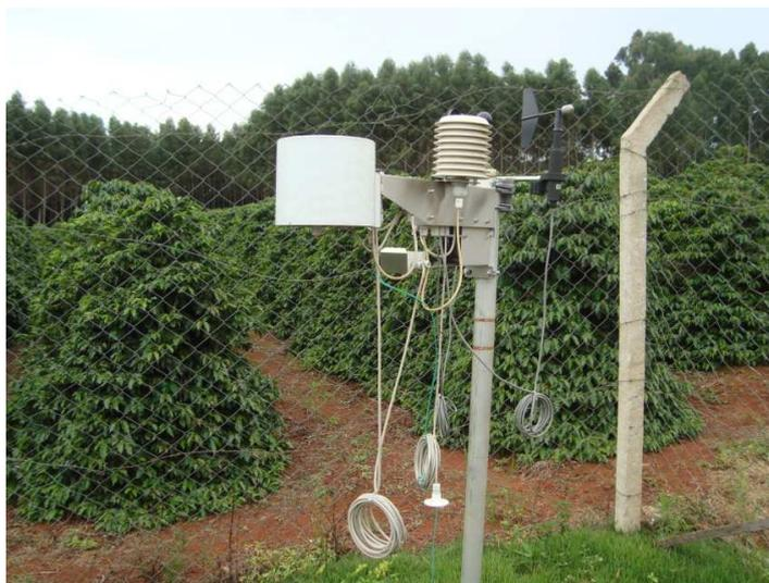
Figura 5 Estação meteorológica automática de aquisição de dados
