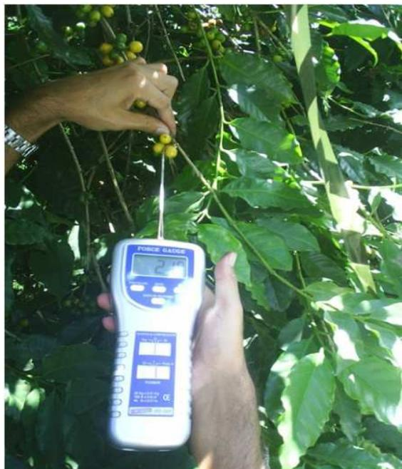
Figura 3 Dinamômetro digital portátil para a determinação da força de desprendimento dos frutos
