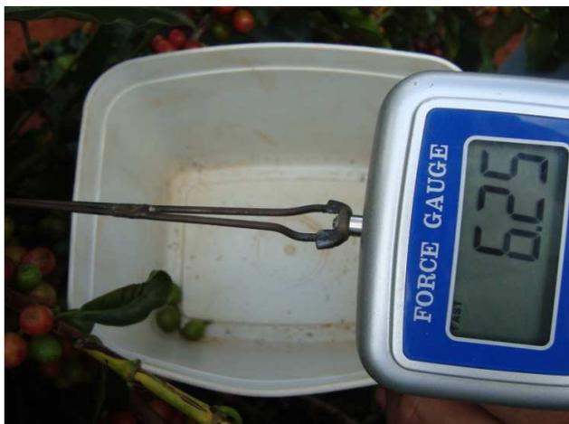
Figura 4 Avaliação da força de desprendimento e coleta dos frutos para determinação da umidade
