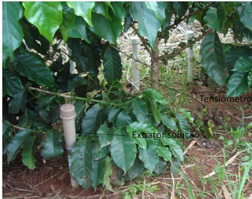
Figura 2. Detalhe da instalação dos tensiômetros e do extrator de solução.
