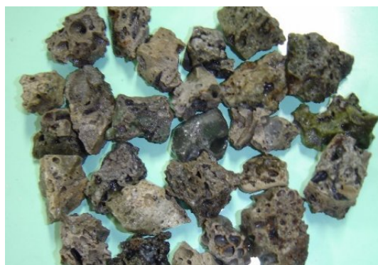
Figura 4.5. Detalhe da escória de alto-forno utilizada como material suporte
