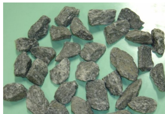
Figura 4.7. Detalhe da brita de rocha gnáissica utilizada como material suporte
