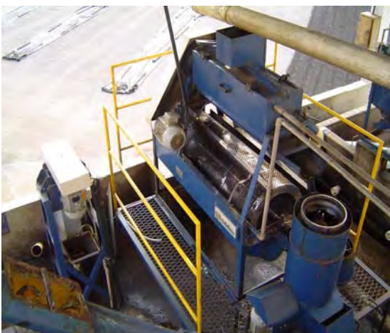
Figura 4 – Detalhe das máquinas de descascamento e desmucilagem
