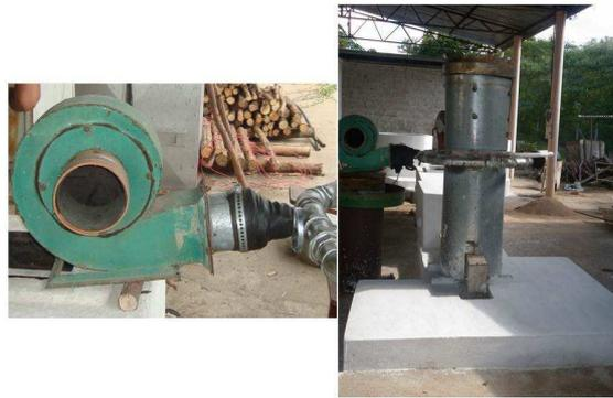
Figura 4 - (a) Reator de gaseificação construído; (b) Sistema de ventilação acoplado a câmara de combustível dentro do reator do gaseificador.
