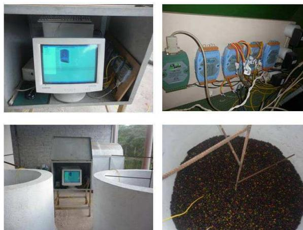
Figura 13 - Café cereja nos silos secadores e sistema de aquisição de dados.
