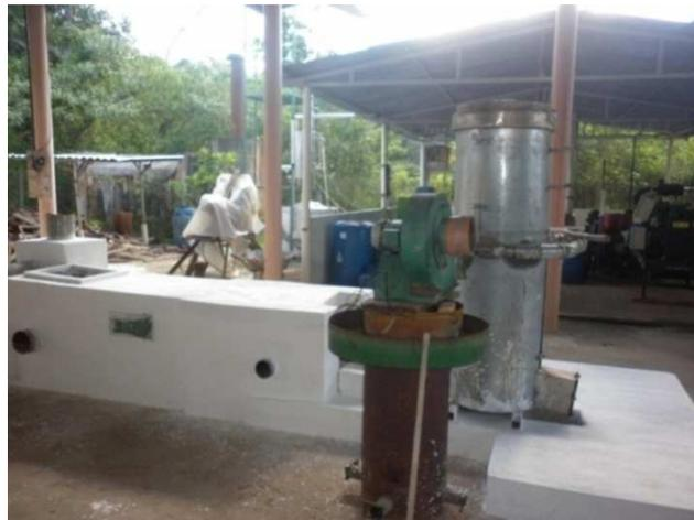
Figura 7 - Gaseificador depois de construído.
