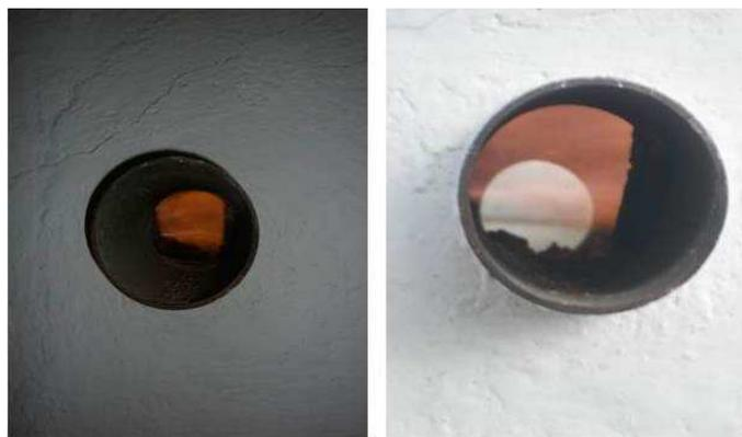
Figura 23 - Início da produção de chama pelo gaseificador, visualizada através da aberturas laterais presentes no combustor de gases.
