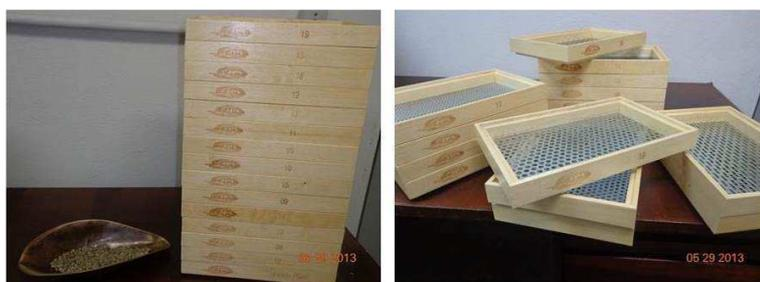
Figura 19 - Amostra de 100 g de café utilizada e conjunto de peneiras utilizadas na classificação por peneiras.
