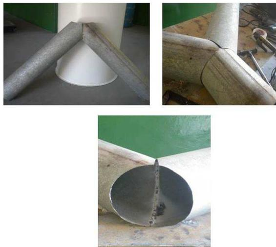
Figura 9 - Bifurcação em Y para distribuição do ar nos silos secadores.
