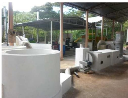
Figura 14 - Sistema gaseificador-silos construído para secagem de café.
