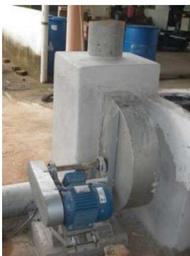
Figura 11 - Sistemas de ventilação para insuflação do ar de secagem nos silos secadores.
