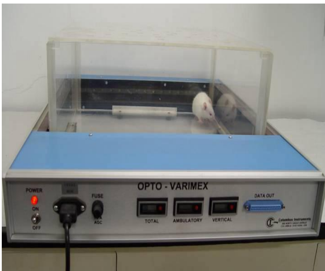
Figura 1: Caixa para medida da atividade locomotora (Columbus Instruments-EUA).
