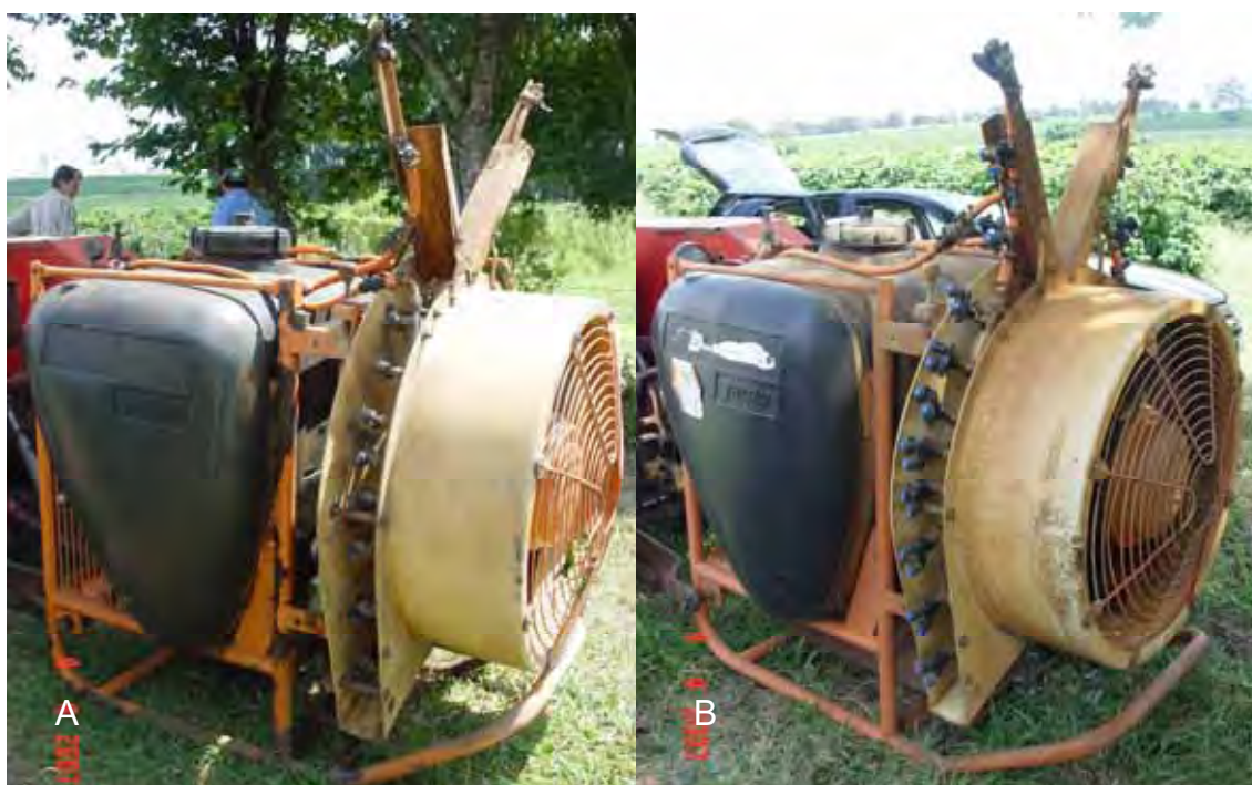
Figura 1. Equipamentos utilizados para a aplicação das caldas acaricidas. (A) ramal convencional, (B) ramal duplicado.
