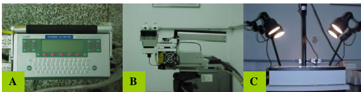
Figura 3 - Equipamentos utilizados na medição de fotossíntese: console do IRGA (A), câmara de CO 2 (B) e mesa digitalizadora de imagens Delta T Devices (C)
