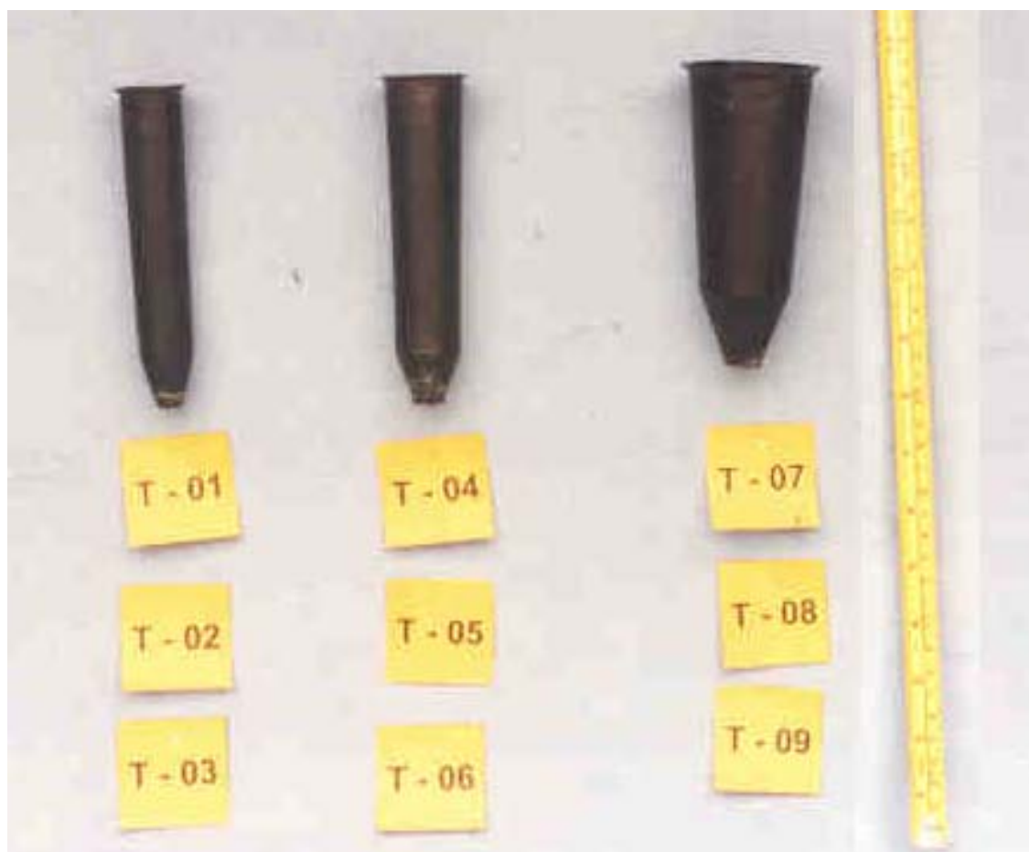
Figura 2 – Tubetes com capacidade para 50, 120 e 200 cm 3 de substrato, utilizados no experimento
