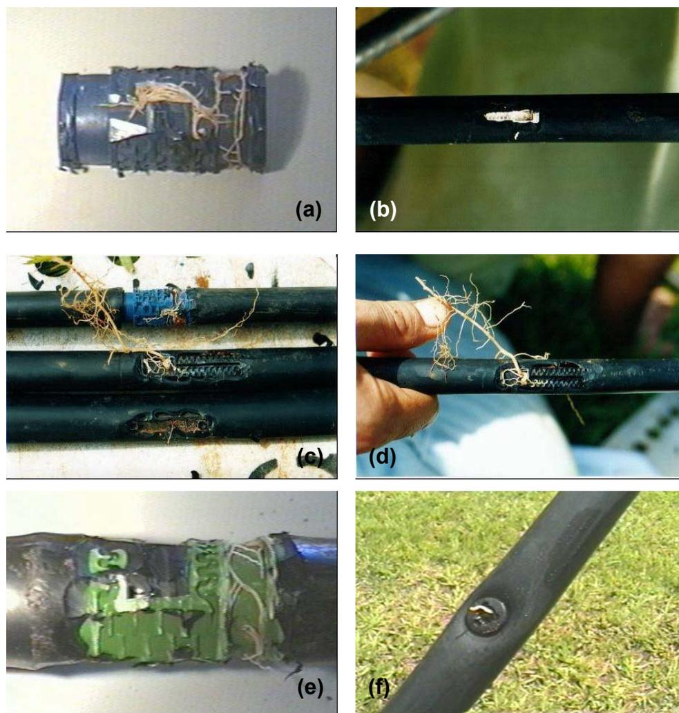
Figura 25 – Intrusão radicular nos emissores: (a) emissor cilíndrico; (b) emissor plano; (c) emissores diversos; (d) emissor plano; (e) emissor cilíndrico; (f) emissor botão.
