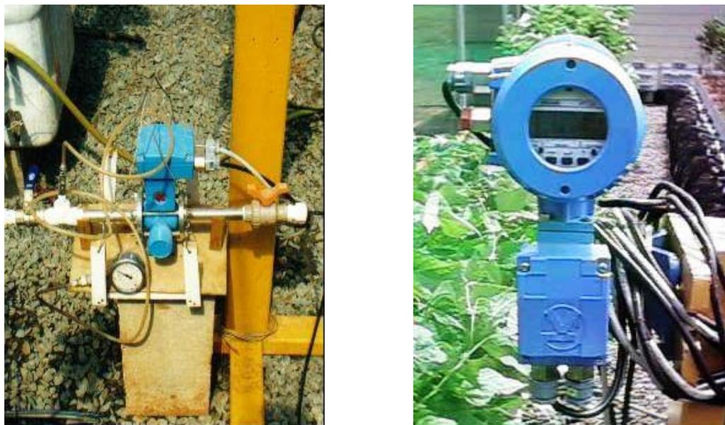
Figura 7 – Detalhes do medidor de vazão: (a) sensor magnético e (b) leitor digital.
