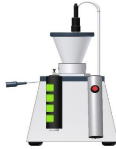
Figura 1. Dispositivo desenvolvido para liberar populações da broca-do-café, o sistema de funcionamento é com ar e calor.
