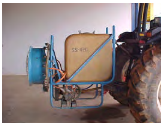
Figura 1. Conjunto trator/pulverizador utilizado nos ensaios de estudo do fluxo de ar.
