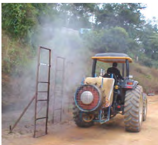
Figura 4. Suportes para fixação das ripas com etiquetas amostradoras e equipamento de aplicação.
