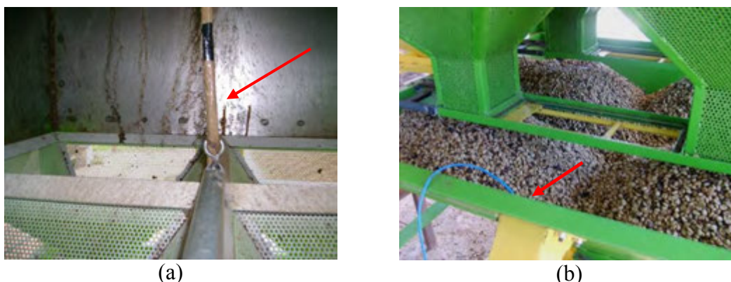
Figura 3.30 - Detalhes do posicionamento dos termopares: (a) posicionamento do cabo de aço dentro do secador; (b) sensor de temperatura posicionado na moega de descanso/homogeneização.
