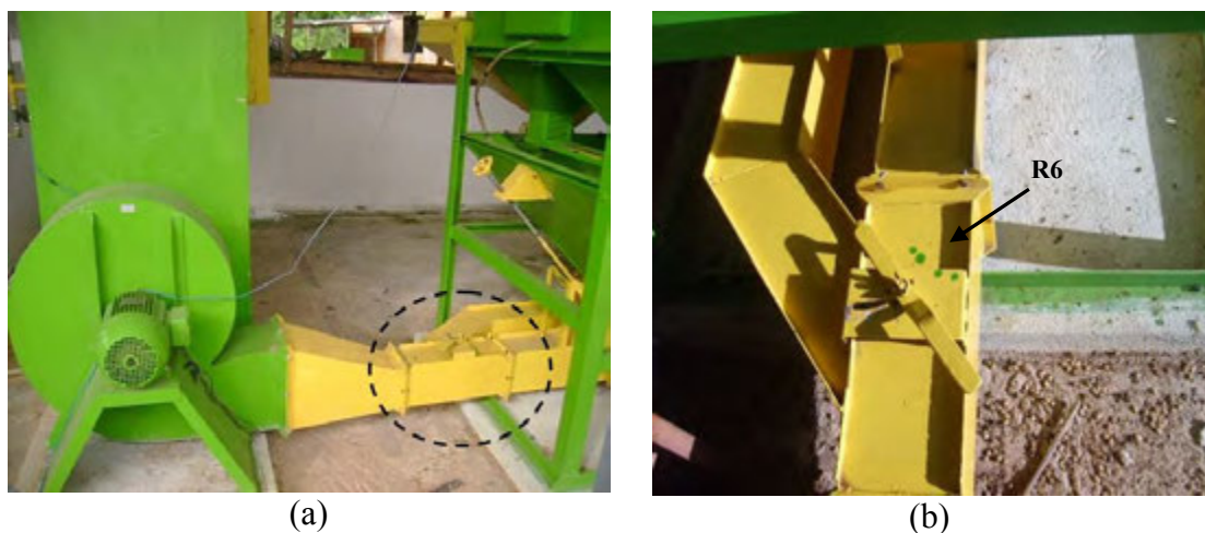
Figura 3.16 - Sistema de ventilação: (a) conjunto motor-ventilador; (b) registro de divisão do ar aquecido para o pré-secador e secador pneumático.
