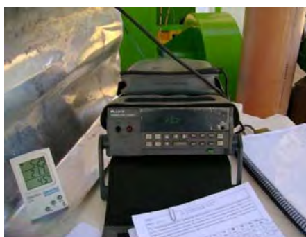
Figura 3.31 - Unidade de aquisição de dados e sensor integrado de leitura de temperatura e umidade relativa.
