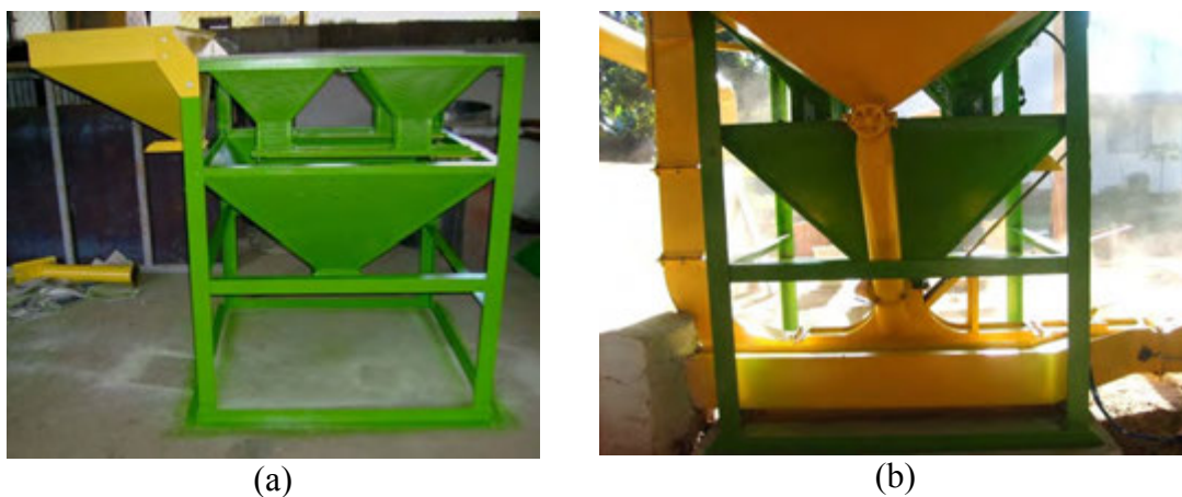
Figura 3.10 - (a) Fixação dos módulos, 1, 2 e 6; (b) ligação da moega de recepção ao duto de transporte pneumático (ar/grãos).
