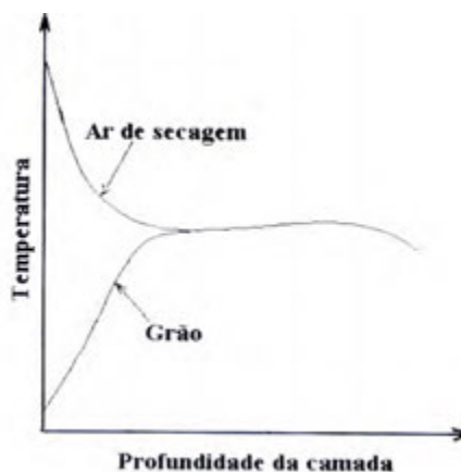
Figura 2.2 - Curvas das temperaturas do ar de secagem e do produto, em função da profundidade, em secador de fluxos concorrentes.
