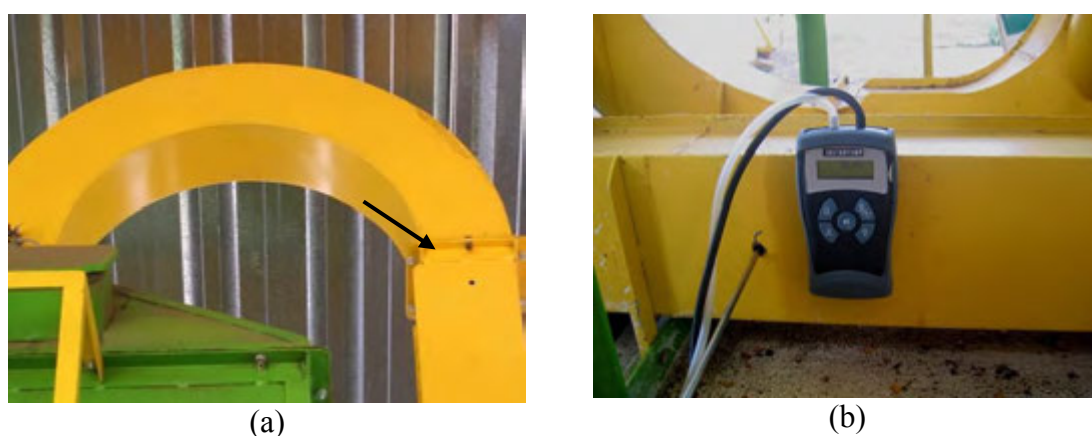
Figura 3.33 - Detalhes dos pontos de medição da velocidade do ar aquecido:(a) topo do secador; (b) duto do pré-secador.
