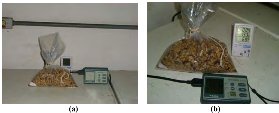
FIGURA 4 - Procedimento para medição da atividade de água e da temperatura da massa de grãos de café
