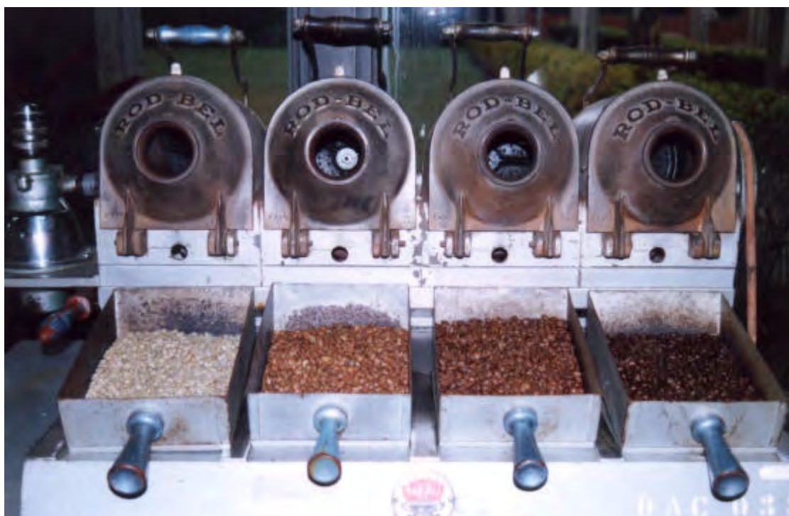
Figura 1 – Sistema de torrefação. Torrefador contínuo com grão verde (à esquerda) e os três tipos de torra, clara, expresso e escura.
