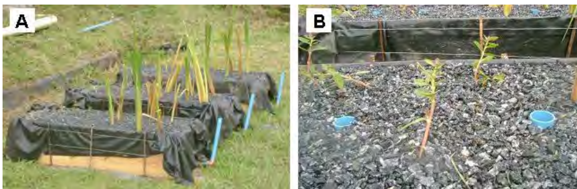
Figura 3.2. Vista geral dos SACESFs após o plantio da alternantera e da taboa (A) e detalhe das mudas de alternantera em crescimento no meio suporte (B).
