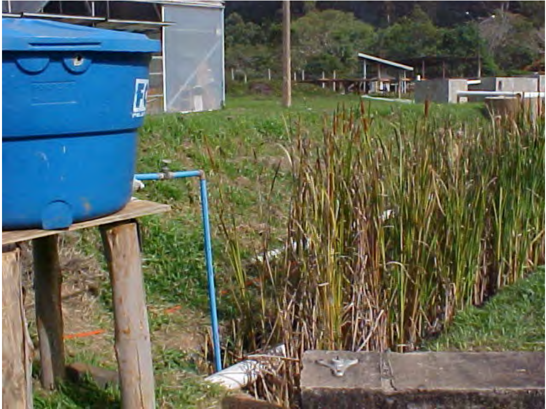
Figura 1.2. Vista geral do sistema alagado construído, destacando-se a senescência da taboa, após 3 dias de aplicação da ARC na taxa de 850 \text{ kg ha}^{-1} \text{ d}^{-1} de DBO.
