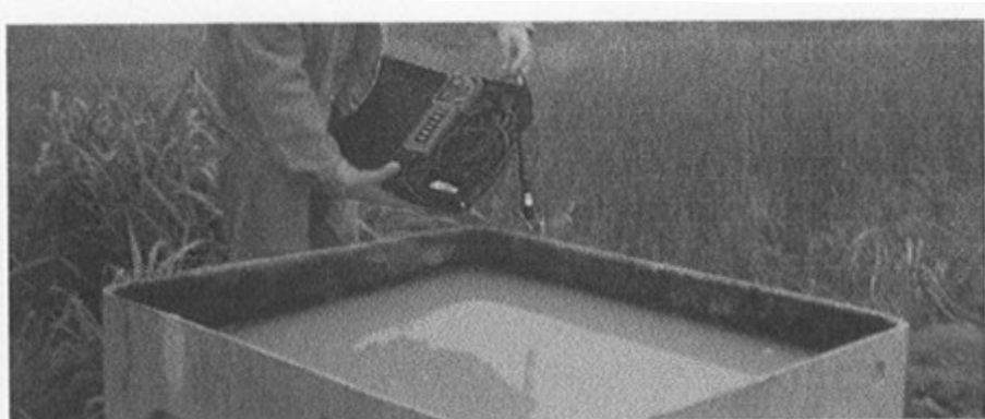
Figura 4 – Condutivímetro usado para determinação diária da condutividade elétrica da ARC durante o período experimental.
