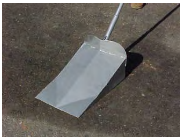
Figura 9 - Rodo raspador-enleirador para café em terreiro.
