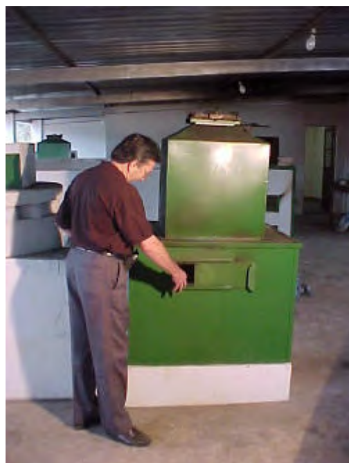
Figura 8 - Regulagem da entrada de ar primário na câmara de combustão
