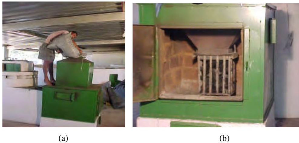
Figura 7 - (a) Carregamento da fornalha; (b) Posicionamento da célula de queima na câmara de combustão
