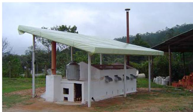
Figura 5. Detalhes de um secador que usa energia da biomassa e um teto coletor solar.
