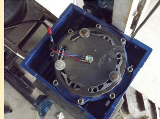
Sensor de posicionamento da roda (potenciômetro)
