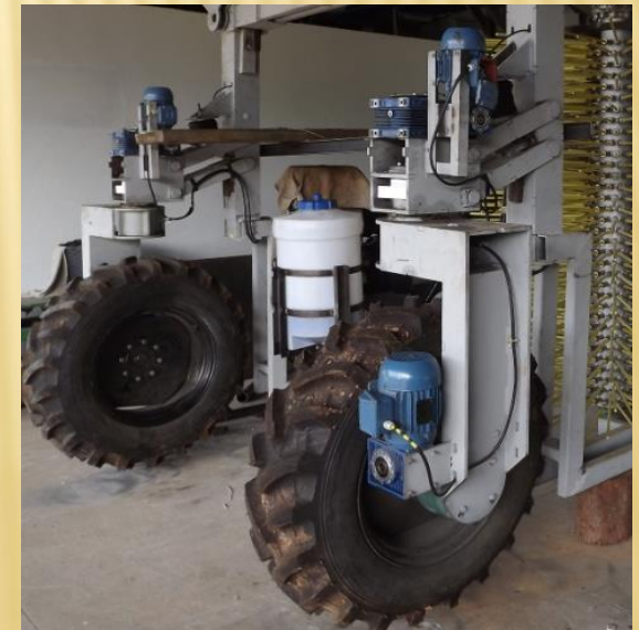
Sensor de posicionamento da roda (potenciômetro)
