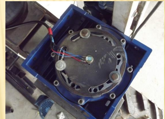
Sensor de posicionamento da roda (potenciômetro)
