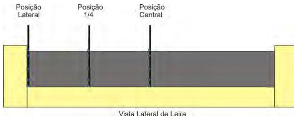
Figura 7 – Posicionamento dos termopares ao longo das leiras do secador.
