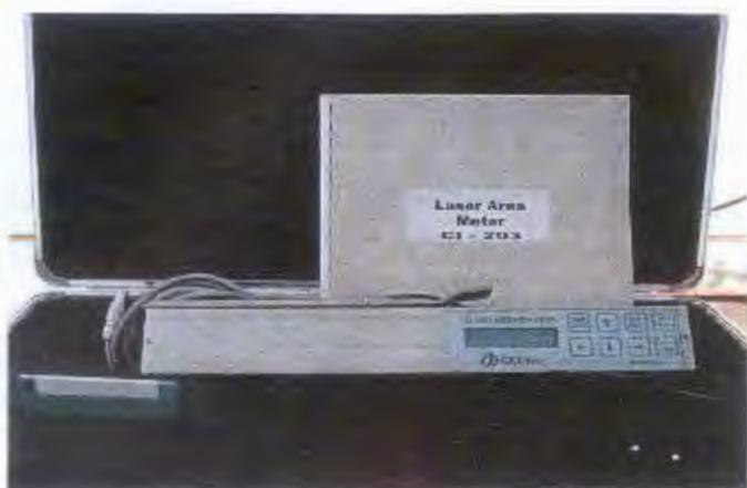
FIGURA 3. Medidor laser de área foliar (Laser Area Meter CI-203 – CID Incorp.).
