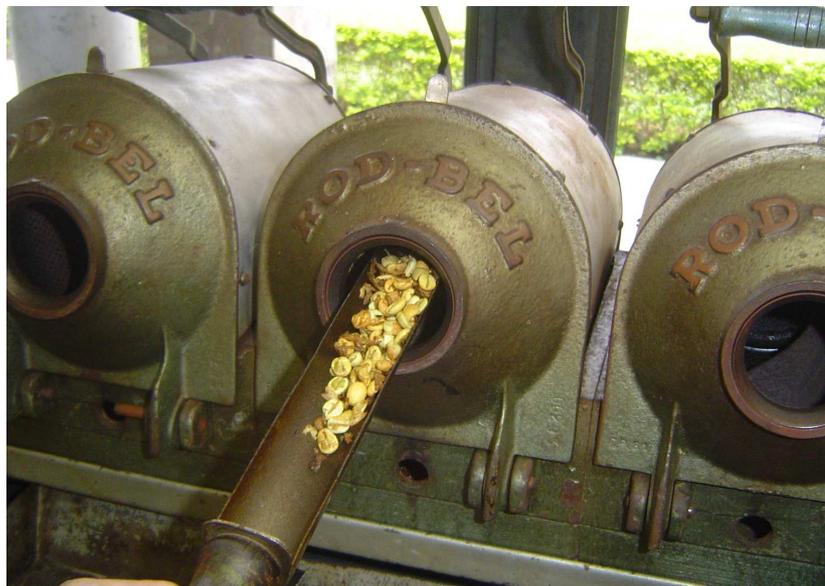
Figura 1 - Torrefador a gás de combustão direta e cilindro rotativo perfurado.
