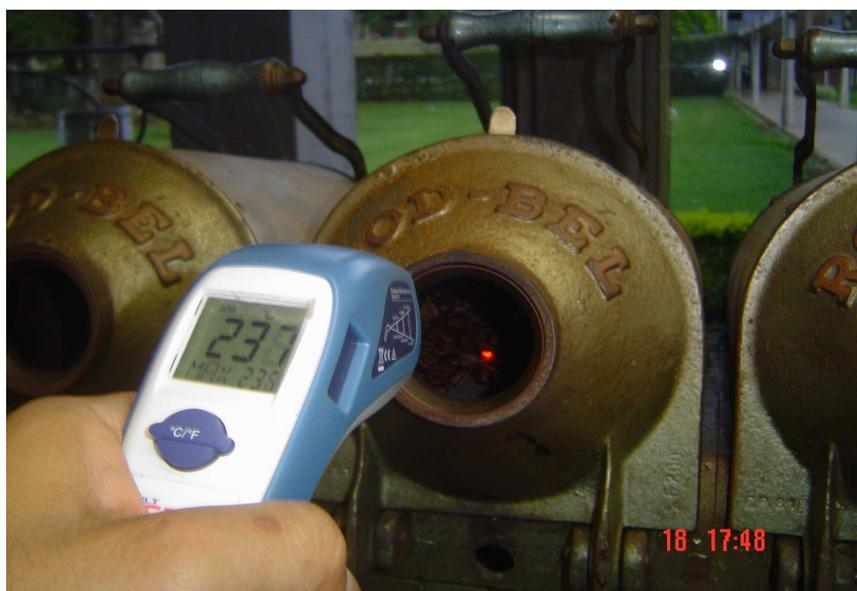
Figura 2 – Medição da temperatura na superfície da massa dos grãos de café.
