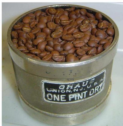
Figura 2 - Recipiente metálico de volume fixo 0,55061 L (*one-pint dry U.S.*).
