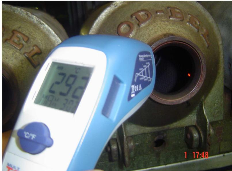
Figura 2 - Medição da temperatura na parede do cilindro rotativo do torrefador.
