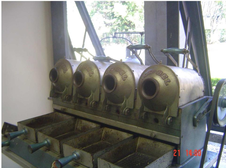
Figura 1 - Torrefador de cilindro rotativo perfurado de combustão direta de gás.
