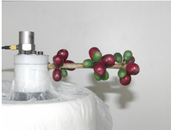
Figura 4. Engastamento do ramo de café na base móvel da máquina vibradora.
