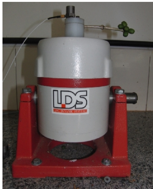
Figura 5. Ramo de café com frutos de maturação verde engastado na base móvel do equipamento vibrador.
