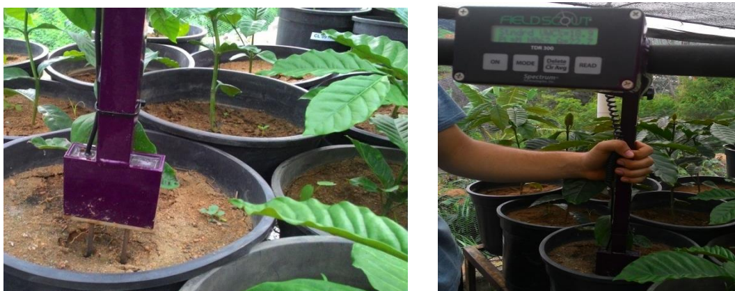
Figura 04. Monitoramento da umidade do solo pelo método da reflectometria no domínio do tempo (TDR).
