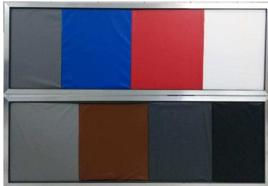
Figura 2.3. Placa para calibração radiométrica composta de oito alvos.
