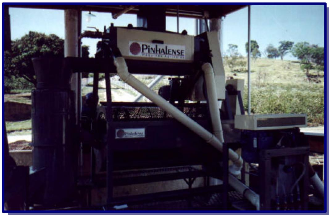
Figura 15: Descascador de cerejas, marca Pinhalense.
