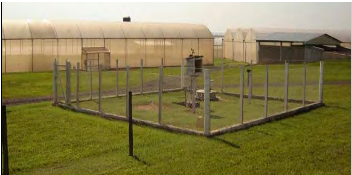
Figura 3. Estação climatológica da fazenda para medição dos dados climatológicos.
