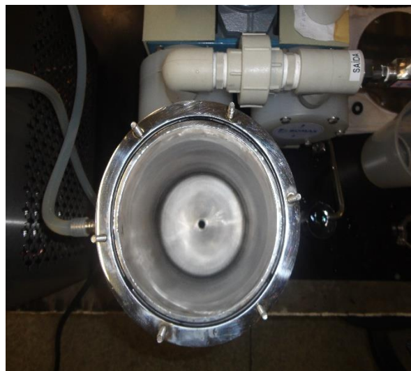
FIGURA 3.3 - TANQUE DE ALIMENTAÇÃO DA UNIDADE EXPERIMENTAL.
