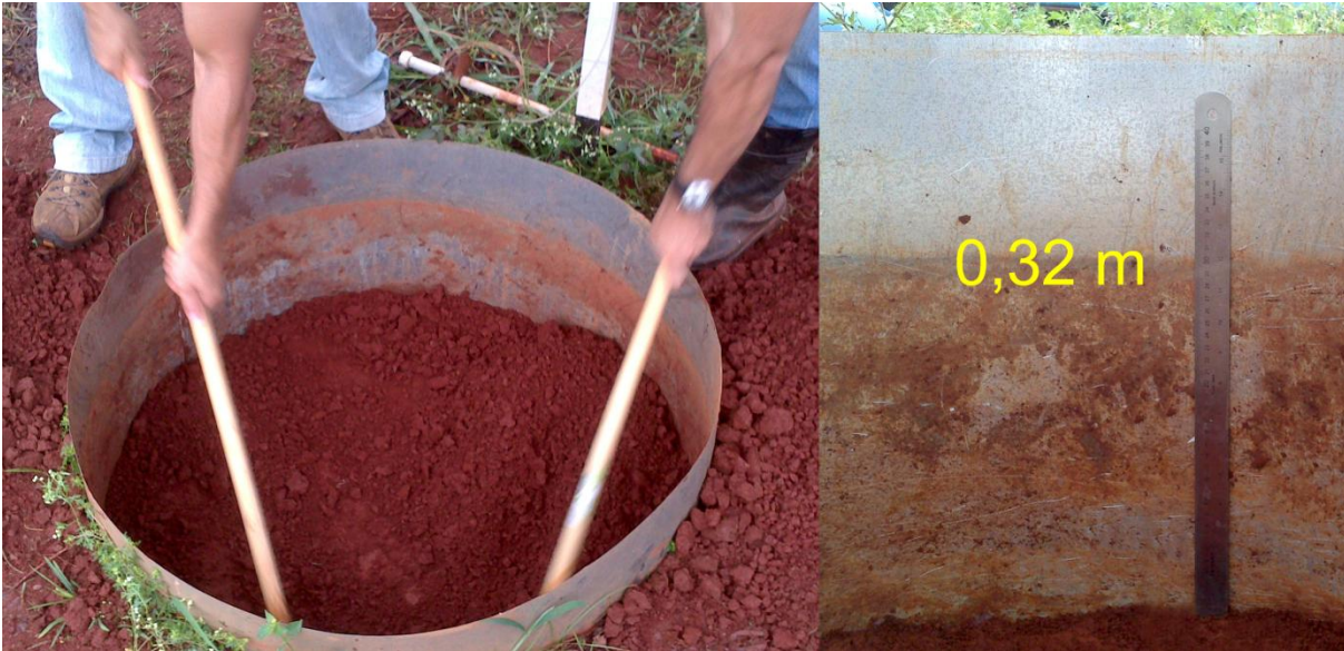
Figura 6 - Retirada do solo para a coleta de amostras indeformadas
