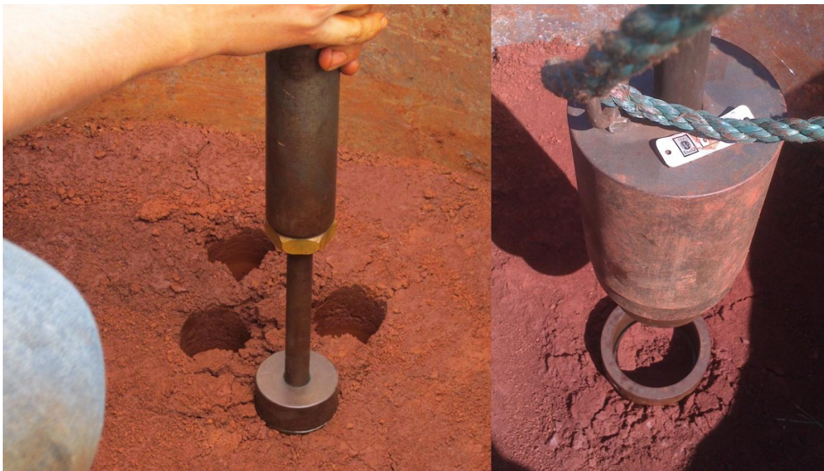
Figura 7 - Coleta de amostras indeformadas com extrator tipo Uhland
