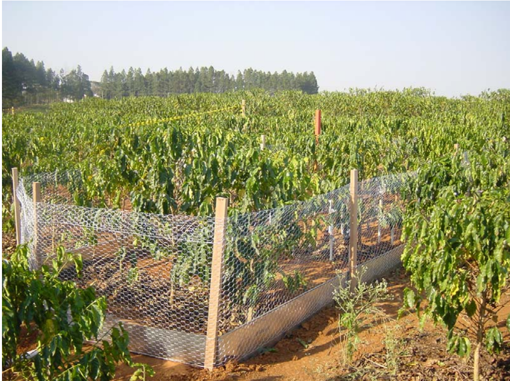
Figura 6 - Diques de metal utilizados para delimitar as sub-parcelas e recolher o escoamento superficial
