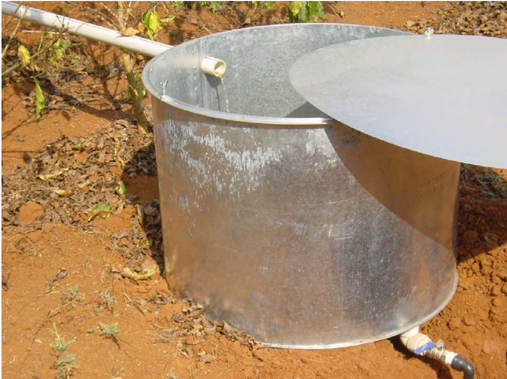
Figura 7 - Detalhe do tanque de 60 litros para coleta do escoamento superficial
