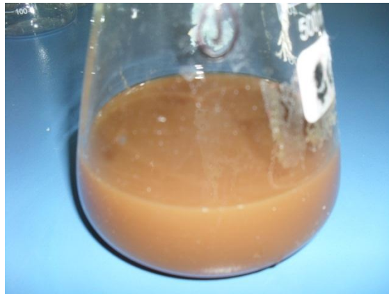
Figura 17 - Hidrolisado hemicelulósico da casca de café tratado com 100 mg/g H_2SO_4 após filtração a vácuo.
