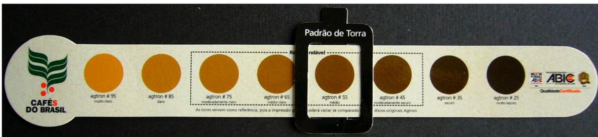
Figura 10 – Discos padronizados da Agtron Roast Color Classification System
